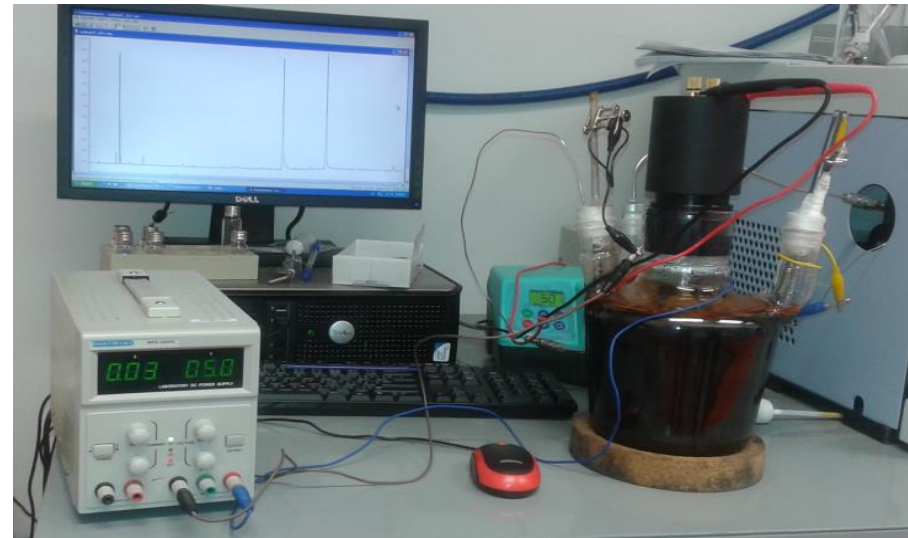
Obr: a) Blokové schéma reaktoru se zavedenými elektrodami v kombinovaném uspořádání; b) dvojitý reaktor oddělený iontovou membránou ; c) Fotografie dokumentující průběh reaktorových testů s nZVI a DC – kombinované uspořádání. Autor: TUL.
